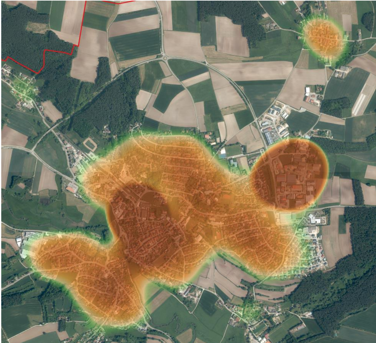
Abbildung 2: Exemplarischer Ausschnitt zur Darstellung der Wärmedichte auf Grundlage des gebäudescharfen Wärmekatasters der Stadt Windsbach
